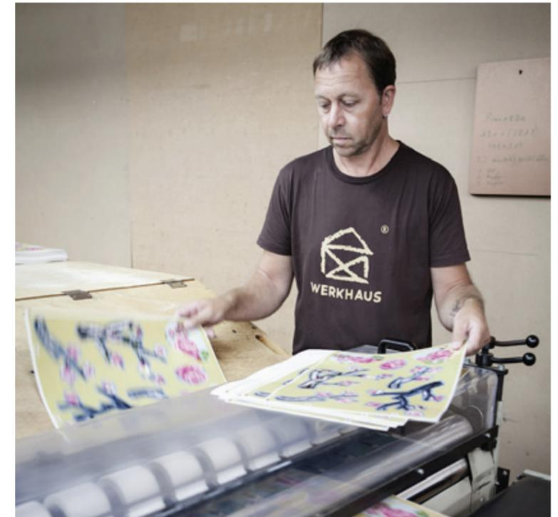
An der Bogenkaschiermaschine werden die hausgefertigten Drucke auf die vorbereiteten Holzplatten kaschiert. (Foto: @ Dan Hannen)
